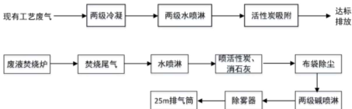
图 3-6 废气处理工艺图
