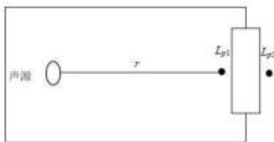
图 6-17 室内声源等效室外声源图例
